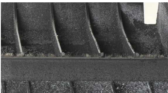
A impressora usando cartuchos da marca nº 3 apresentou acúmulo de toner leve a moderado por toda a guia de alimentação do papel.
