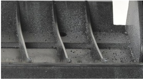
Ao final do teste, a guia interna de alimentação do papel da impressora usando apenas toner Lexmark genuíno estava relativamente limpa, com muito pouco vazamento de toner visível.
