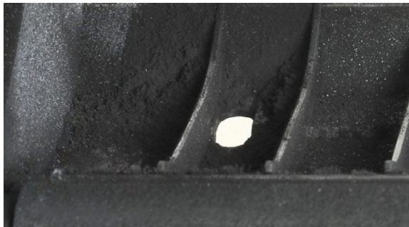
A impressora usando cartuchos da marca nº 1 apresentou acúmulo de toner moderado a intenso por toda a guia de alimentação do papel.
