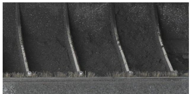
A impressora usando cartuchos da marca nº 4 apresentou acúmulo de toner moderado a intenso por toda a guia de alimentação do papel.
