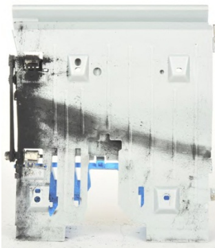
Após imprimir 96.895 páginas, o trajeto do papel da impressora usando cartuchos da marca nº 1 exibiu vazamento moderado de toner em um lado e vazamento leve no outro lado.
