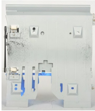
Após imprimir 244.325 páginas, o trajeto do papel da impressora usando apenas toner Lexmark genuíno estava relativamente limpo, com muito pouco vazamento de toner visível.
