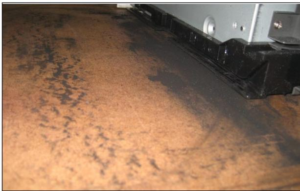
A mitad de las pruebas de BLI, se observó en la máquina utilizada con los cartuchos de tóner de la marca 4 un derrame de tóner excesivo en las superficies próximas al dispositivo. Otros cartuchos no originales presentaron problemas de fugas de tóner similares durante las pruebas.
