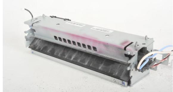
En cambio, la unidad de fusión de la impresora utilizada con los cartuchos de la marca 4 presentó no solo contaminación por tóner, sino también indicios de algún tipo de contaminación rosácea/rojiza. Tratándose de una impresora monocromo como la MS610, la presencia de tóner de color no está justificada.
