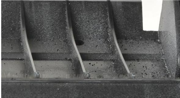
Al final de las pruebas, la guía de alimentación de papel interna de la impresora que utilizó únicamente tóner original Lexmark estaba relativamente limpia, con un nivel de derrame de tóner apenas visible.
