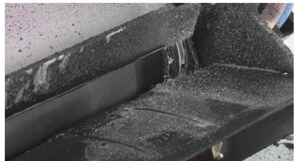
La impresora que utilizó los cartuchos de la marca 4 presentó una contaminación por tóner importante en la guía de entrada de la unidad de fusión, con grandes zonas de tóner derretido en diferentes superficies de la guía.
