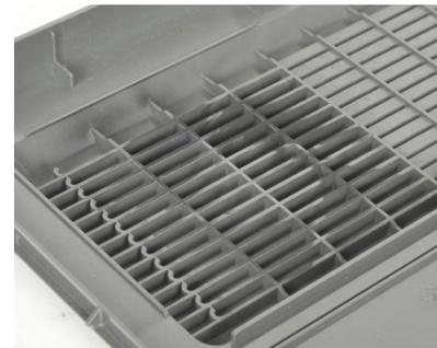
La impresora que utilizó los cartuchos de la marca 2 presentó unos residuos de tóner entre ligeros y moderados en la cubierta de ventilación.
