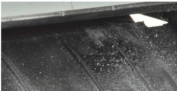
La impresora que utilizó los cartuchos de la marca 3 presentó una contaminación por tóner moderada en la guía de entrada de la unidad de fusión, con zonas de tóner derretido en algunas superficies de la guía.
