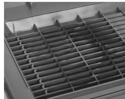
La impresora que utilizó los cartuchos de la marca 4 presentó unos residuos de tóner entre moderados e importantes en la cubierta de ventilación.
