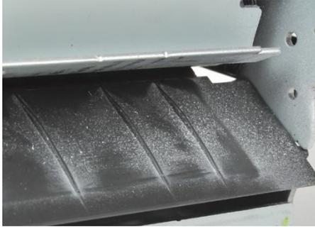
Las guías de entrada de la unidad de fusión de la unidad de fusión MS610 que utilizó únicamente cartuchos de tóner originales Unison de Lexmark presentan únicamente rastros de polvo de papel (en forma de manchas blancas) en la guía de entrada de papel de la unidad de fusión. Las guías de entrada de la unidad de fusión que utilizó únicamente tóner original Unison de Lexmark no presentaron ningún tipo de residuos de tóner.
