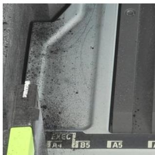
La impresora que utilizó los cartuchos de la marca 3 presentó unas fugas de tóner leves en el interior del cajón de papel.
