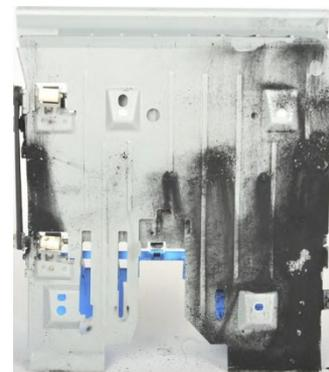
Después de imprimir 223.719 páginas, la impresora que utilizó los cartuchos de la marca 4 presentaba unas fugas de tóner leves en un lado y unas fugas importantes en el otro lado de la ruta de papel.
