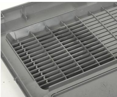
La impresora que utilizó los cartuchos de la marca 3 presentó unos residuos de tóner entre ligeros y moderados en la cubierta de ventilación.
